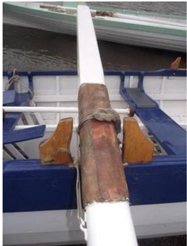
Von der Kastendolle (hier an einem Nachbau des ersten im Rennen von Oxford und Cambridge verwendeten Boots von 1829)...
