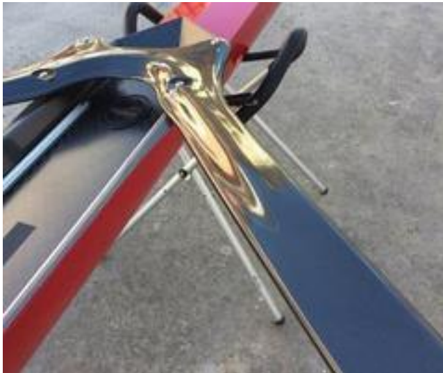
...zum Carbon-Flügel ausleger (hier an einem Einer der italienischen Werft Salani)
