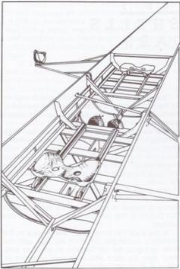
3 Erfindungen auf dem Weg zum modernen Ruderboot: Ausleger, Drehdolle und Rollsitz
